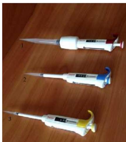
Пипетка-дозатор — приспособление, используемое в лаборатории для отмеривания определённого объёма жидкости. Пипетки выпускаются переменного и постоянного объёма. В комплекты оборудования для медицинских классов входят удобные пипетки-дозаторы одноканальные, позволяющие настроить необходимый объём отбираемой жидкости в трёх различных диапазонах (рис. 6). Использование современных техно-
