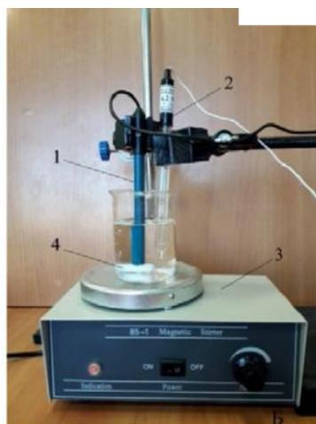
*Датчик рН* предназначен для измерения водородного показателя (рН) . В настоящее время в школу поступают комбинированные датчики, совмещающие в себе стеклянный электрод с электродом сравнения, что делает работу по измерению водородного показателя более комфортной. Диапазон измерений рН от 0—14. Используется для измерения водородного показателя водных растворов в различных исследованиях объектов окружающей среды .
