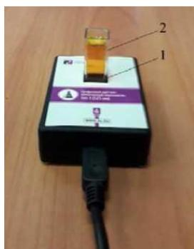
комплект входят датчики с различной длиной волн полупроводниковых источников света: 465 и 525 нм. Объем кюветы составляет 4 мл, длина оптического пути —10 мм.
