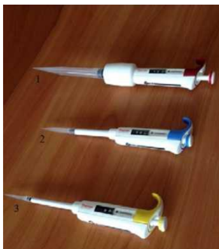
Рис. 5. Пипетки дозаторы одноканальные переменного объёма: 1 — 110 мл; 2 — 100—1000 мкл; 3 — 10—100
